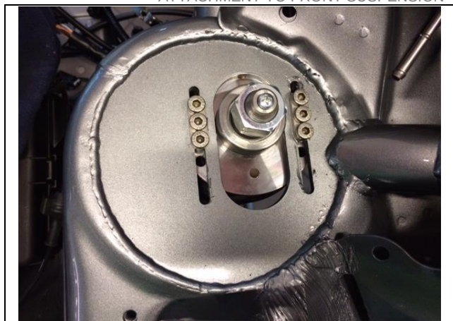
FOTÓ 9 PHOTO 9 RÖGZÍTÉS AZ ELSŐ FUTÓMŰ TORONYHOZ ATTACHMENT TO FRONT SUSPENSION
