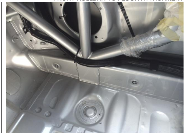
ELSŐ BUKÓCSŐ RÖGZÍTÉSE A PADLÓLEMEZHEZ FRONT ROLLBAR TO FLOOR ATTACHMENT
