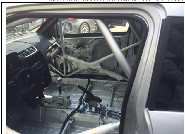
FOTÓ 8 PHOTO 8 FŐÍV RÖGZÍTÉSE A "B" OSZLOPHOZ MAIN ROLLBAR ATTACHMENT TO "B" PILLAR
