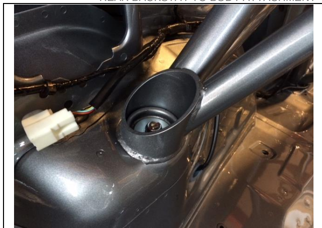
HÁTSÓ LETÁMASZTÓ RÖGZÍTÉSE A KAROSSZÉRIÁHOZ REAR BACKSTAY TO BODY ATTACHMENT
