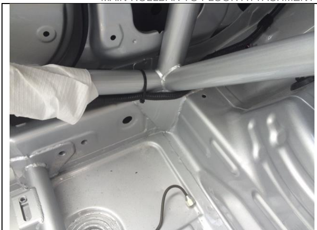
FOTÓ 4 PHOTO 4 FŐÍV PADLÓLEMEZHEZ RÖGZÍTÉSE MAIN ROLLBAR TO FLOOR ATTACHMENT
