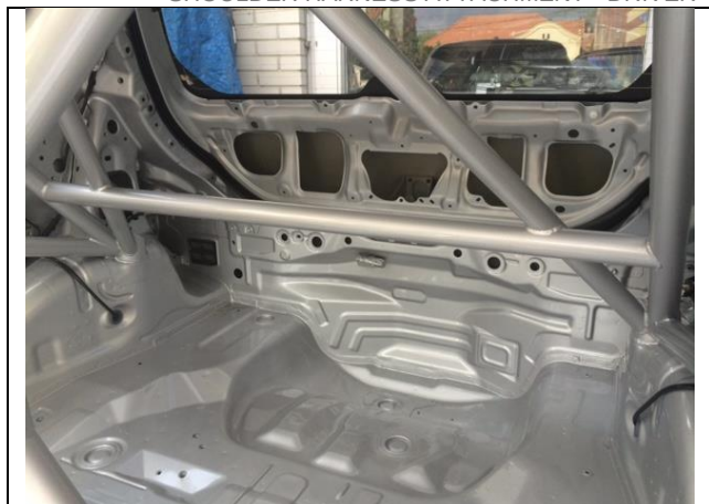
FOTÓ 13 PHOTO 13 VEZETŐ OLDALI VÁLL ÖV RÖGZÍTÉSE SHOULDER HARNESS ATTACHMENT - DRIVER
