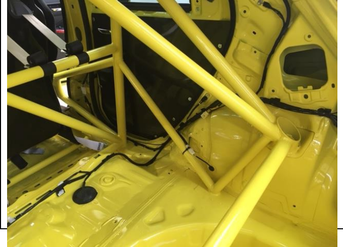
FOTÓ 7 PHOTO 7 ELSŐ BUKÓCSŐ RÖGZÍTÉSE AZ "A" OSZLOPPOHOZ FRONT ROLLBAR ATTACHMENT TO "A" PILLAR
