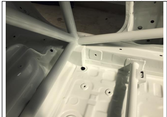
FOTÓ 4 PHOTO 4 FŐÍV PADLÓLEMEZHEZ RÖGZÍTÉSE MAIN ROLLBAR TO FLOOR ATTACHMENT
