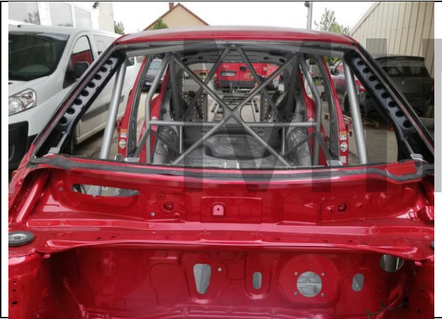
FOTÓ 7 PHOTO 7 ELSŐ BUKÓCSŐ RÖGZÍTÉSE AZ "A" OSZLOPPOHOZ FRONT ROLLBAR ATTACHMENT TO "A" PILLAR
