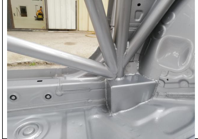
FOTÓ 6 PHOTO 6 ELSŐ BUKÓCSŐ RÖGZÍTÉSE A PADLÓLEMEZHEZ FRONT ROLLBAR TO FLOOR ATTACHMENT
