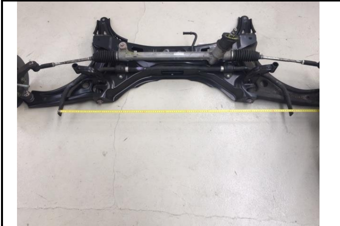
VII-F1) Stabilisátor méretezve Elöl Front stabiliser with dimensions
