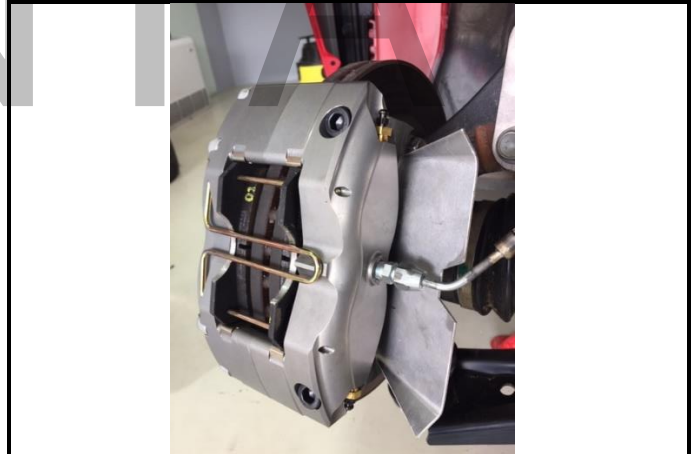
A1-2) Fékhűtés Brake cooling
