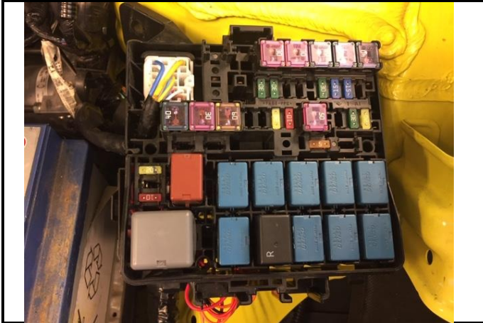
B2-1) Megszakító reléje Safety breaker relay
