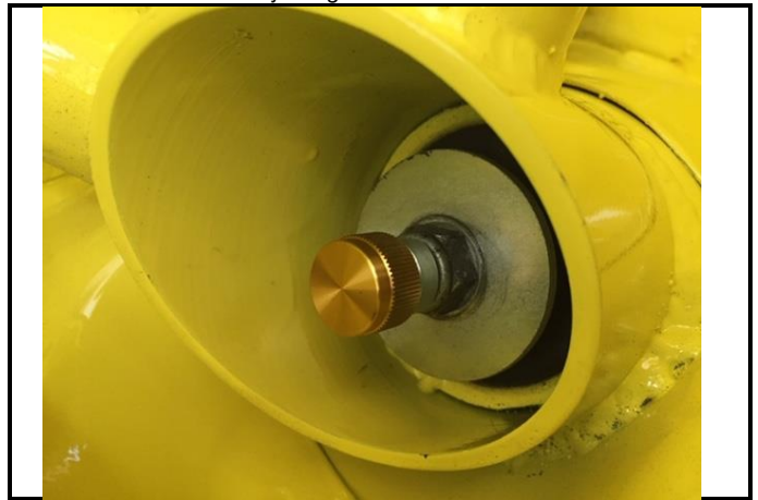
B2-2) Hátsó lengéscsillapító állító csavar Rear absorber adjusting screw
